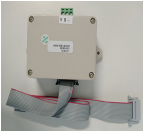
图 20 RS485 联网接口模块及其连接排线
