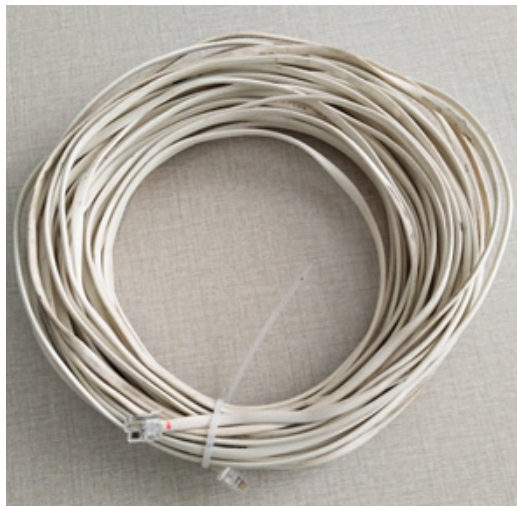
图 24 Wi-Fi 线控器连接线（电话线）
