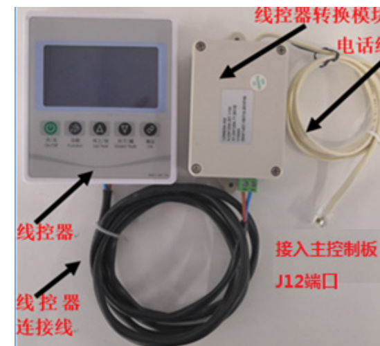
图2 线控器、线控器连接线、线控器转换模块，电话线实物
