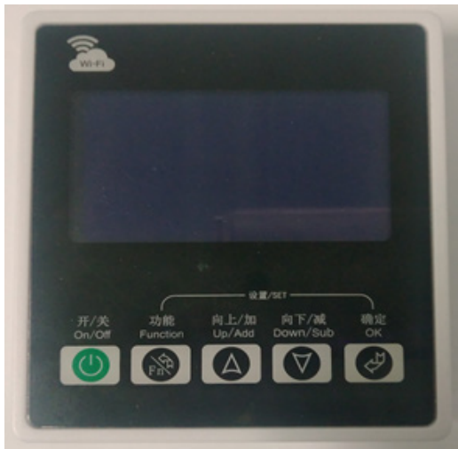
图 23 Wi-Fi 线控器（正面照）
