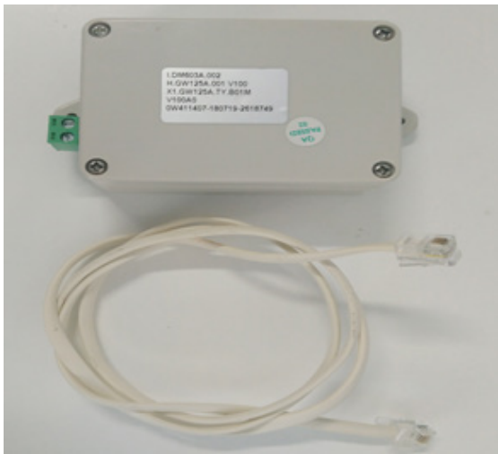
图 19 线控器转换模块及其电话线
