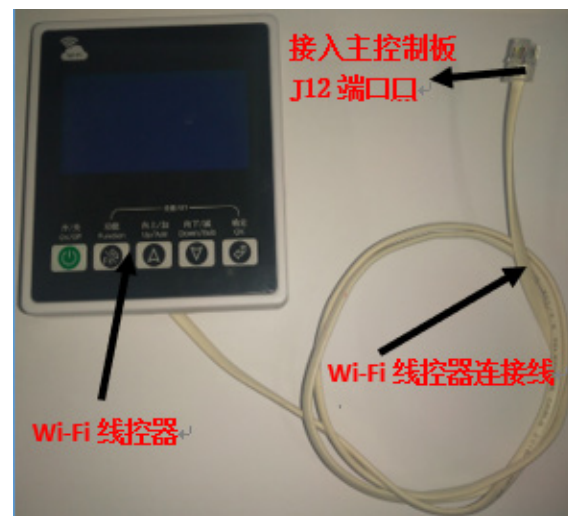
图7 Wi-Fi 线控器及其连接线
