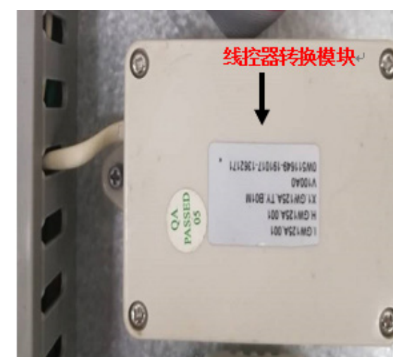
图 5 线控器转换模块安装后实物图
