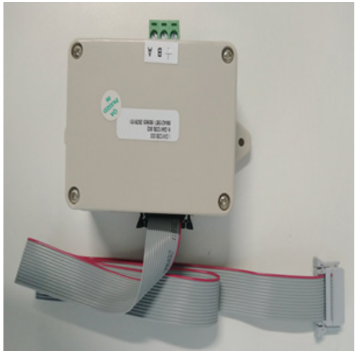
图 27 RS485 联网接口模块及其连接排线
