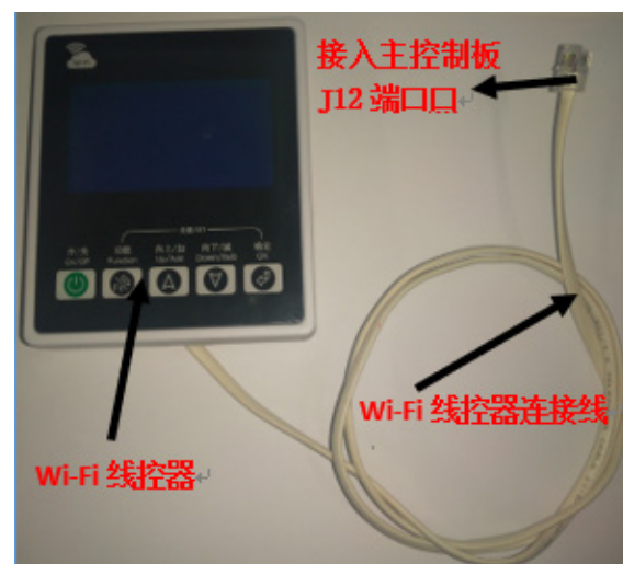
图 7 Wi-Fi 线控器及其连接线
