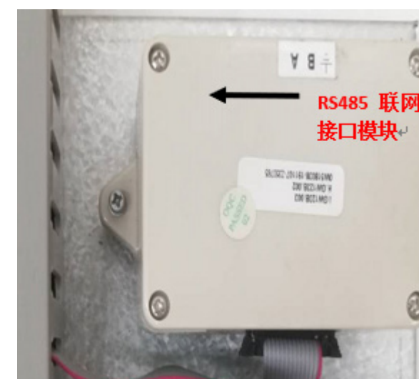
图 12 RS485 联网接口模块安装后实物图
