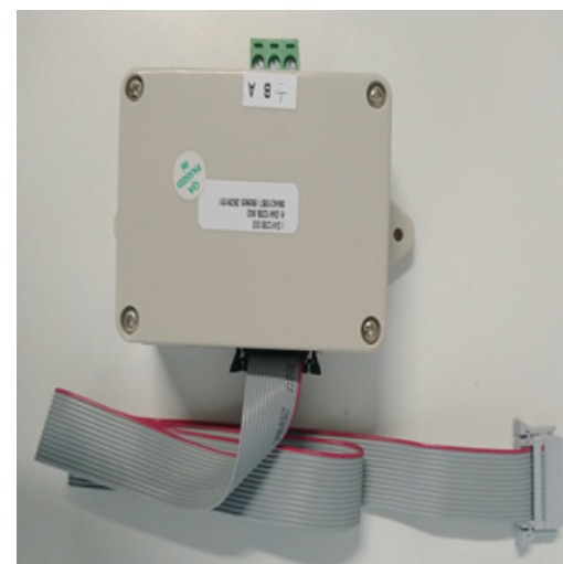
图 27 RS485 联网接口模块及其连接排线
