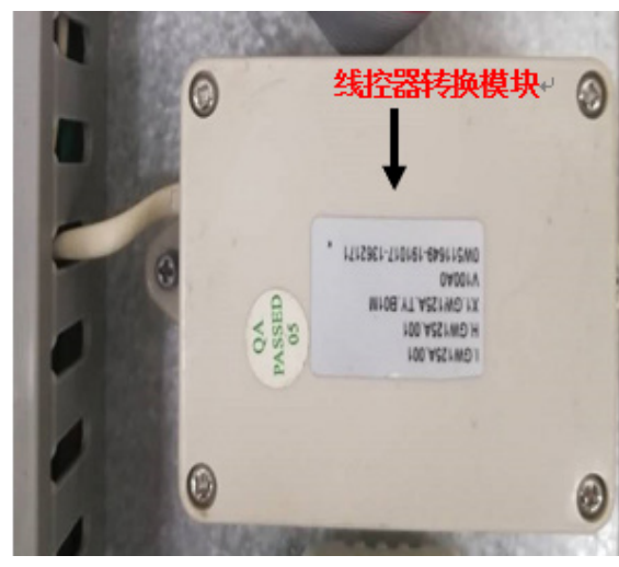
图 5 线控器转换模块安装后实物图
