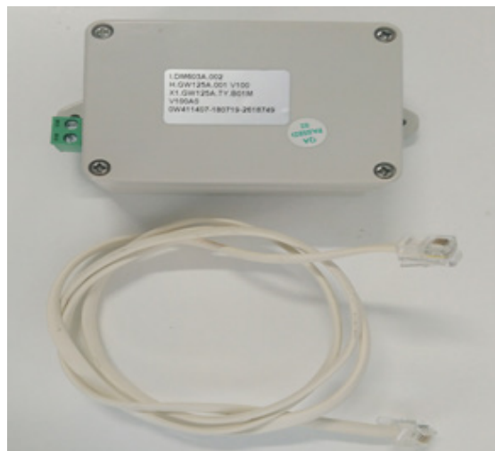
图 19 线控器转换模块及其电话线
